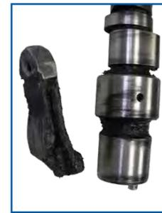
**Symptome:** Verkohlte Ölrückstände auf Nockenwelle, Schlepphebeln und Stößeln.
