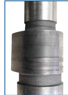
**Symptome:** Laufspuren im mittleren Bereich des Nockens, teilweise auf einer Seite verstärkt auftretend.
