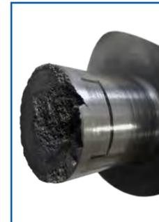
**Symptome:** Nocken, Lagerflächen und Stößel zeigen Spuren mechanischer Einwirkungen.
